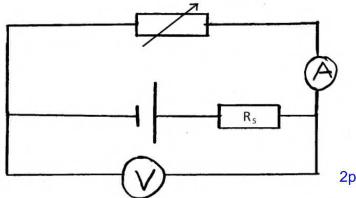
b) Napajännite kuormitetusta jännitelähteestä:
